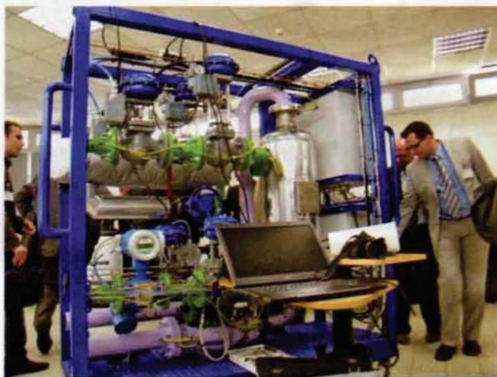
Le Skid de régulation thermique.
